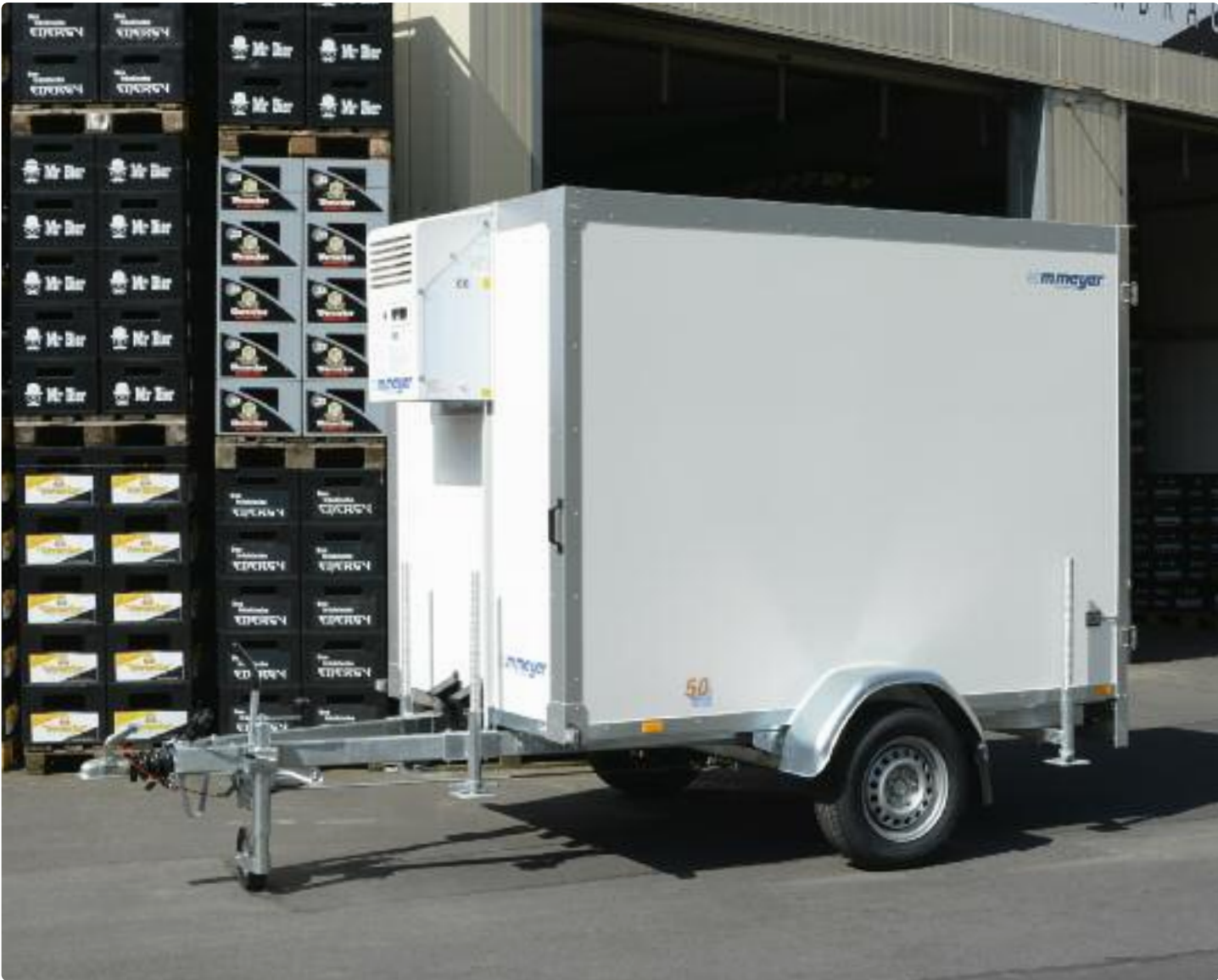
AZKF 1325/145 4 Schwerlaststützen, Kühlmaschine AZKF 1325/145 4 béquilles renforcées, groupe frigorifique AZKF 1325/145 4 reinforced prop stands, cooler unit WMK 4
