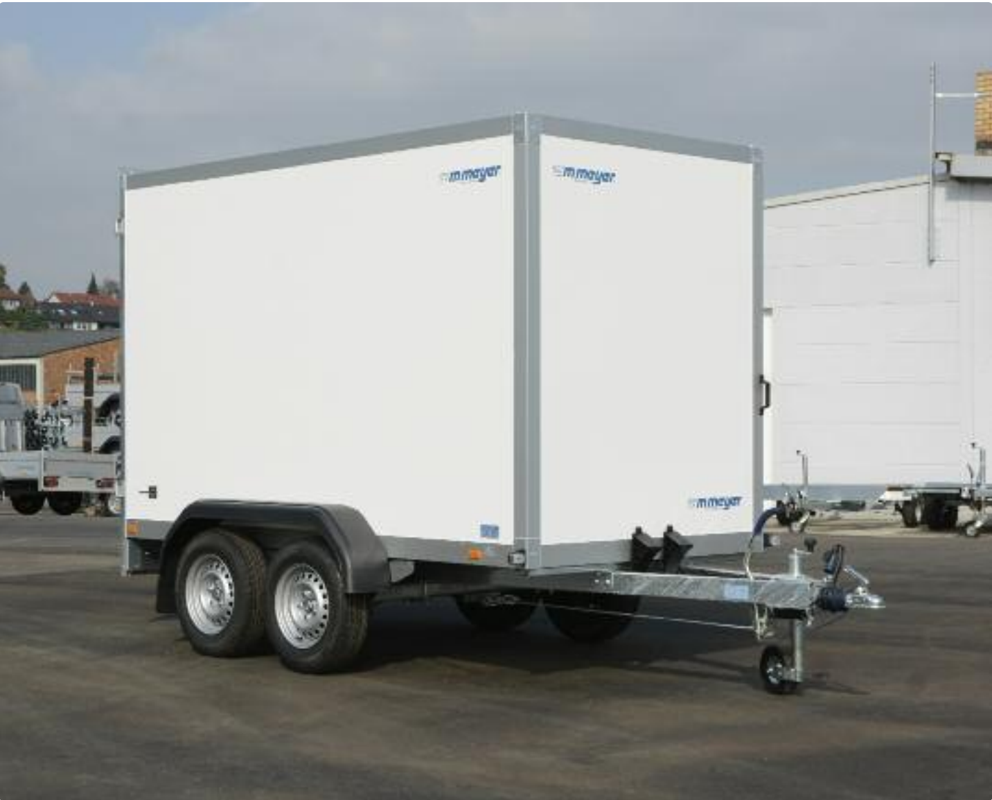
AZ 2030/151 Serie 30 Aluminiumprofile, Wände, Türen und Dach Sandwichpolyester weiß (ähnlich RAL 9016) AZ 2030/151 Série 30 Profilés en aluminium, panneaux, porte et toit en polyester sandwich blanc (~ RAL 9016) AZ 2030/151 Series 30 Aluminium profiles, side panels, door and roof made of white sandwich polyester (~ RAL 9016)
