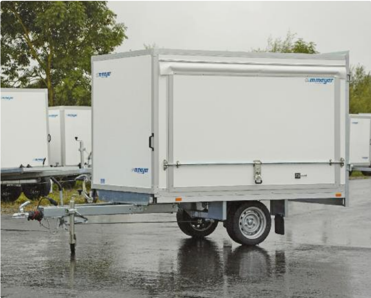
AZHLN 1325/151 Zubehör: Verkaufsklappe (links, mit Drehstangenverschluß in Edelstahl) AZHLN 1325/151 Options : clapet de vente (à gauche, avec fermeture à cremone en inox) AZHLN 1325/151 Optional extra: vending hatch (left, with stainless-steel closing system)
